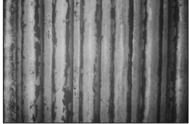
Buhar kazanı kimyasal temizlikten sonraki mikrofımlı temiz boru kesiti
