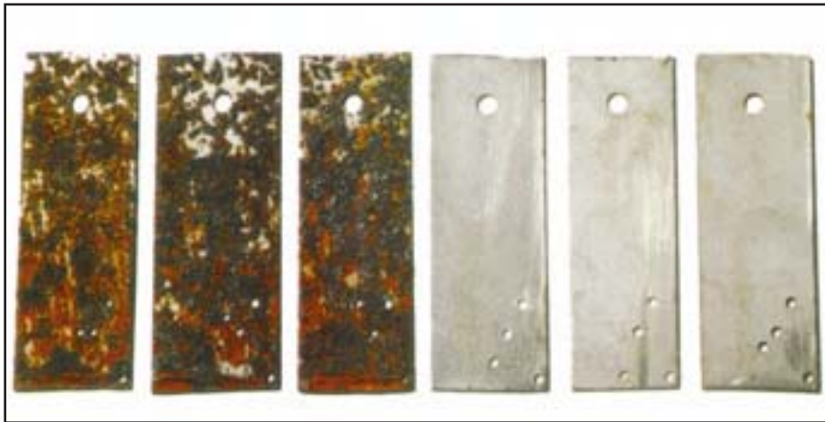
SOĞUTMA SUYU KOROZYON TEST KUPONLARI
