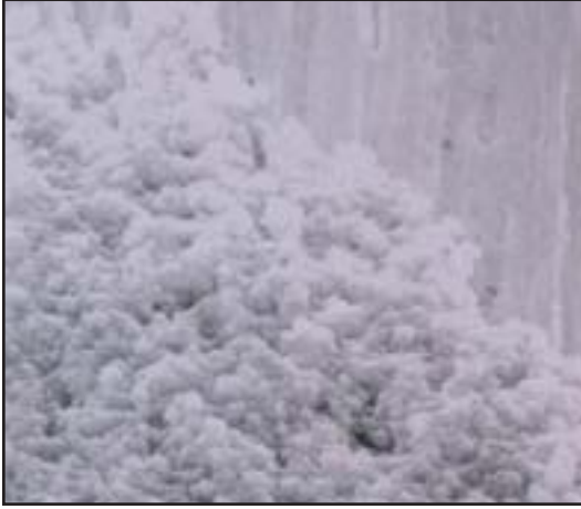
YÜZEYDE KALSİYUM KARBONAT DEPOZİTİ
