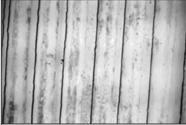
Buhar kazanı kimyasal temizlikten önceki taşlaşmış boru kesiti
