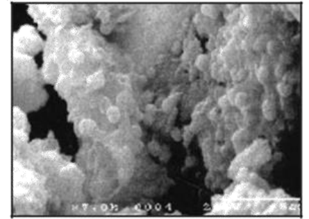
Mikroskobik scale (Taş) incelemesi Ca SO 4
