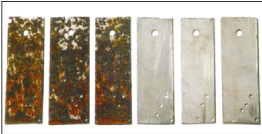
SOĞUTMA SUYU KOROZYON TEST KUPONLARI
