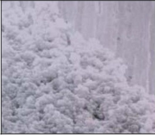
YÜZEYDE KALSİYUM KARBONAT DEPOSITİ
